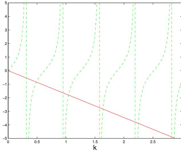
Figura I.1: Il plot contiene i grafici delle funzioni  $y = \tan(xL)$  e  $y = -k \tan \alpha$  per  $L = 5$  e  $\alpha = \frac{\pi}{3}$ . Gli autovalori sono i valori di  $k > 0$  corrispondenti ai loro punti di intersezione.
