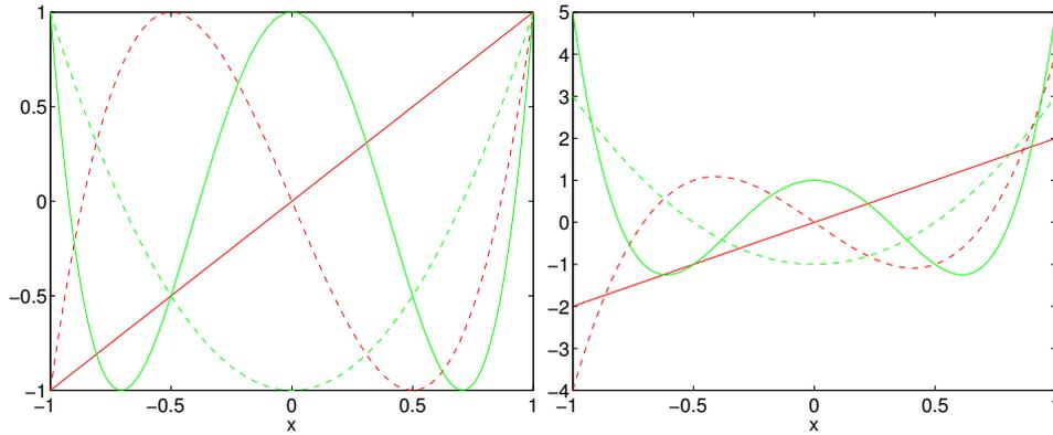
Figura IV.6: I polinomi di Chebyshev di prima e seconda specie di grado 1, 2, 3 e 4. Nel pannello sinistro si trovano i grafici dei polinomi di Chebyshev di prima specie e nel pannello destro quelli di seconda specie. Osserviamo che il numero degli zeri è uguale al grado del polinomio. Inoltre, i polinomi di Chebyshev di prima specie hanno  $\pm 1$  come i loro valori estremi.
