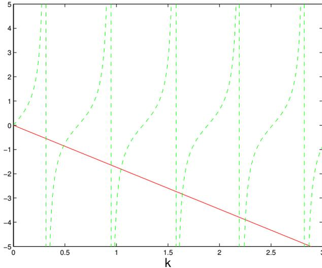
Figura IV.1: Il plot contiene i grafici delle funzioni  $y = \tan(xL)$  e  $y = -k \tan \alpha$  per  $L = 5$  e  $\alpha = \frac{\pi}{3}$ . Gli autovalori sono i valori di  $k > 0$  corrispondenti ai loro punti di intersezione.
