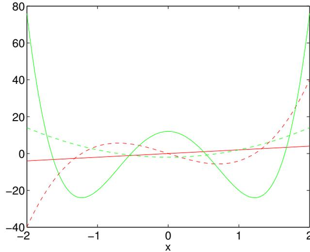
Figura IV.4: I polinomi di Hermite di grado 1, 2, 3 e 4. Osserviamo che il numero degli zeri è uguale al grado del polinomio.
