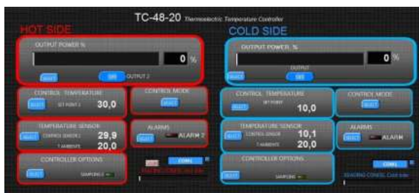
Figura 3.13 – Pannello frontale in LabVIEW
