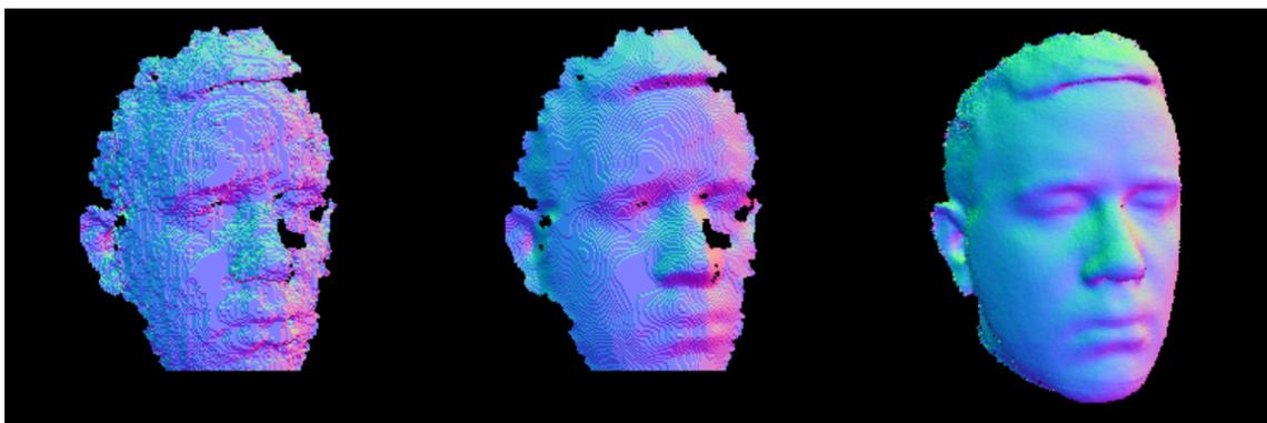
Figura 1.6: Diversi gradi di ricostruzione di un volto con tecnica Multiview
