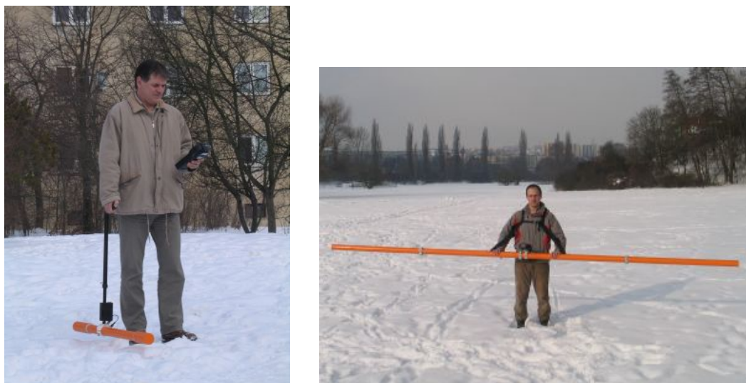
Figura 1: Foto di due GCM GF Instruments , a sinistra il modello CMD-1 , a destra il modello CMD-Explorer .
