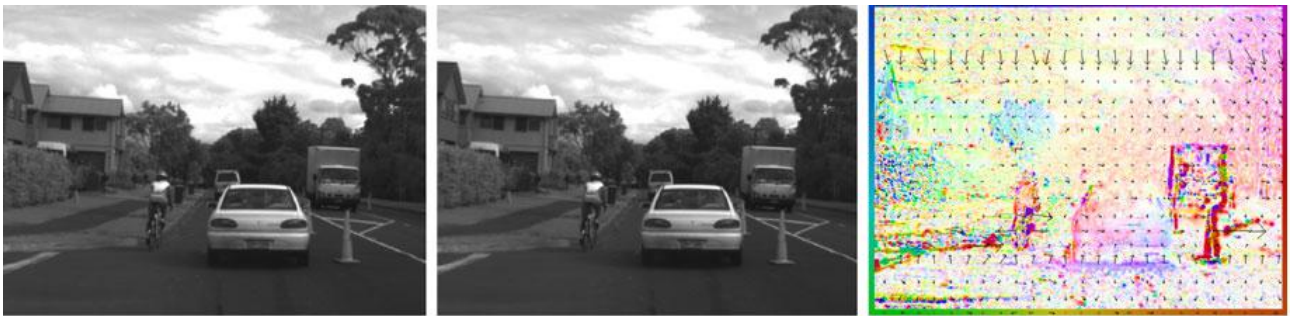
Figura 8: A sinistra ed al centro 2 frame successivi di un video girato a 25fps. A destra la codifica dei vettori del moto coi colori, ottenuta utilizzando l'algoritmo Horn-Schunck.
