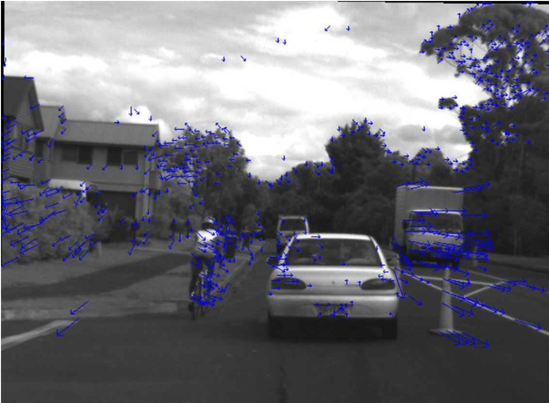
Figura 16: flusso ottico calcolato con l' algoritmo originale di Lucas-Kanade, con k=25 per un insieme 5 \times 5 .
