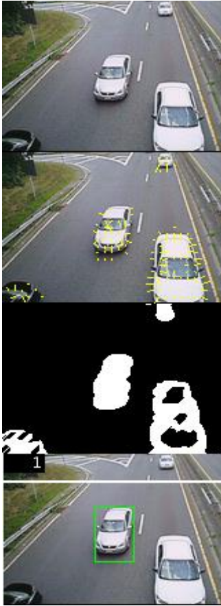
Figura 20: esempio del funzionamento del tool, nella seconda immagine a partire dall'alto si può notare come venga calcolato il flusso ottico delle auto in movimento.
